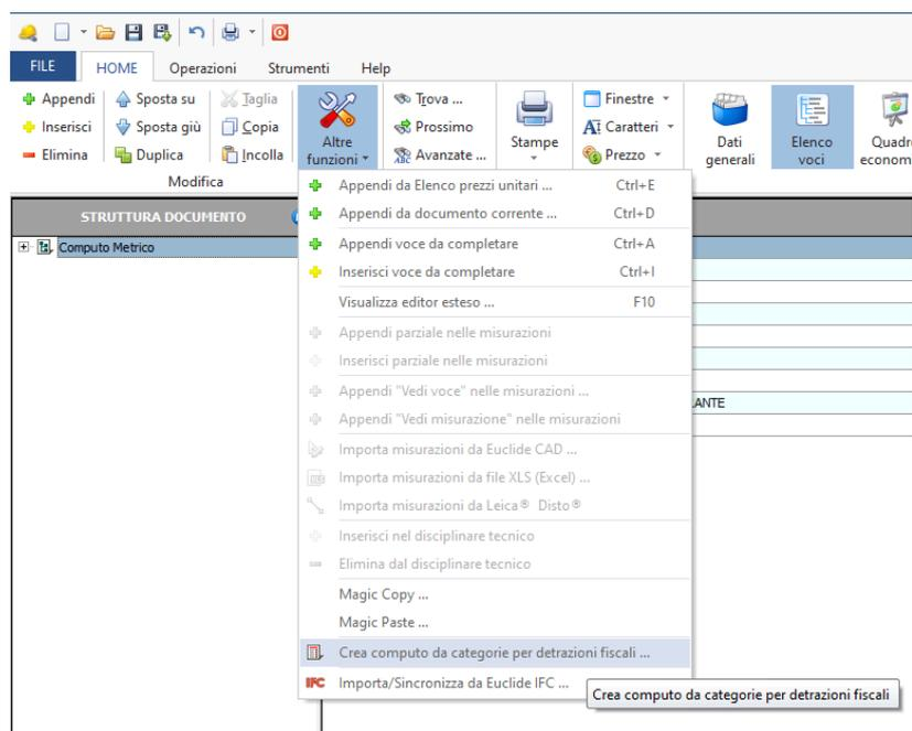
La funzione permetterà di selezionare una o più tipologie (ad esempio fotovoltaico, accumulo e colonnine di ricariche) e produrrà un nuovo computo metrico contenente tutte le categorie, le voci e le misurazioni [precedentemente associate](#).
