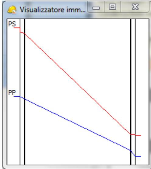
Dettaglio di un diagramma di Glaser
